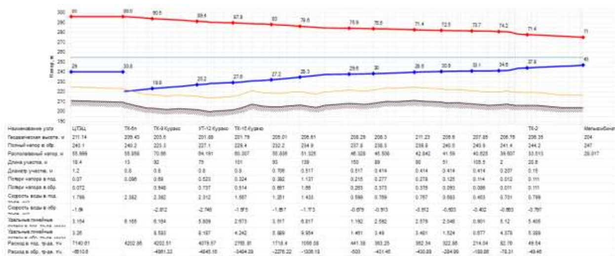
Рисунок 6.4 – Пьезометрический график перспективного гидравлического режима ЦТЭЦ (ЦТЭЦ – Мелькомбинат)
